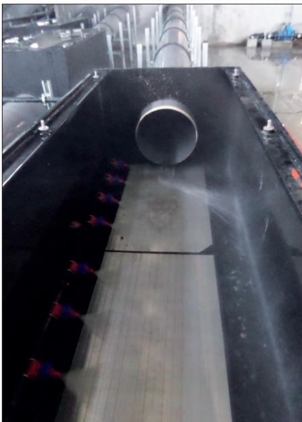
*Filtre AQUALITY DN 400 en mode nettoyage HP automatique*
