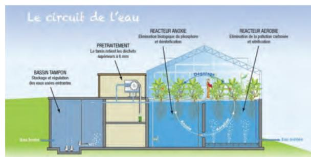
Schéma de fonctionnement d'une station Organica. © OTV
