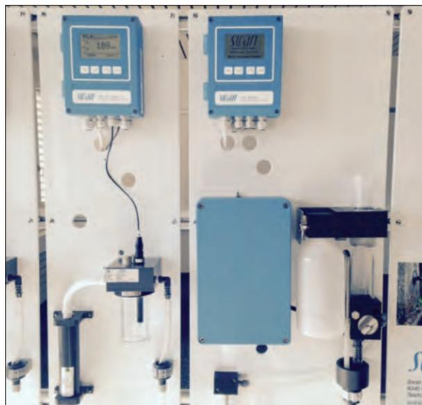
est bien connue, cet appareil est unique dans sa conception et son design (brevet déposé), car son point zéro dit de référence est parfaitement stable. La mesure est donc plus fiable, et la maintenance quasi nulle. Les applications visées sont nombreuses, mais les plus parlantes sont le contrôle de la qualité des eaux brutes, d'une part, et le contrôle de l'efficacité général des différentes étapes de traitement qui pourraient être réalisées selon la qualité d'eau d'origine.
