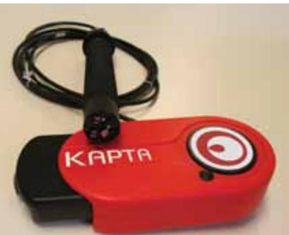
Le capteur d'eau multi-paramètres KAPTA.
