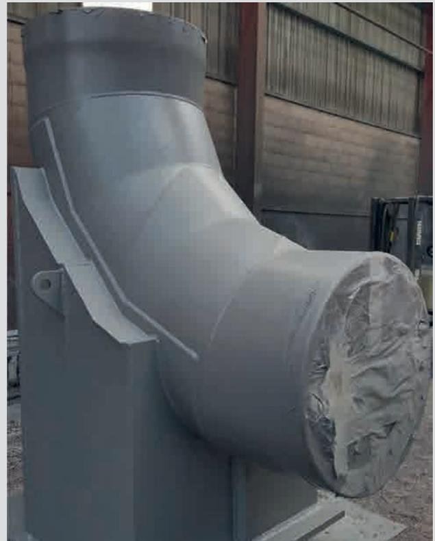
Le produit satisfait aux exigences de performances de la norme NF EN 10290 catégorie Classe B - Type 3 (Tubes et raccords en acier pour canalisations enterrées et immergées - Revêtements externes en polyuréthane ou polyuréthane modifié liquides). Pour les applications en enterrés ou en galeries qui sont contraignantes, nos clients sur site peuvent compter sur les caractéristiques du produit
