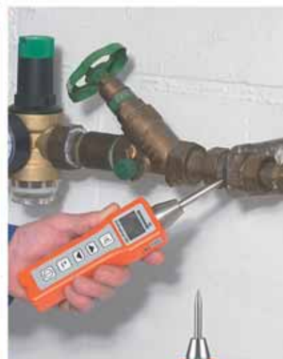
Sectorisation acoustique SePem® GSM
