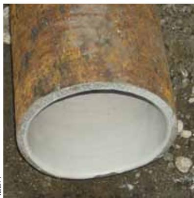
Une canalisation après application de la résine epoxy par pulvérisation centrifuge.
