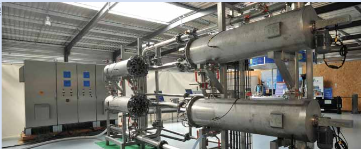
Une des solutions pour éliminer les polluants émergents est la mise en place de réacteurs à UV successifs.
