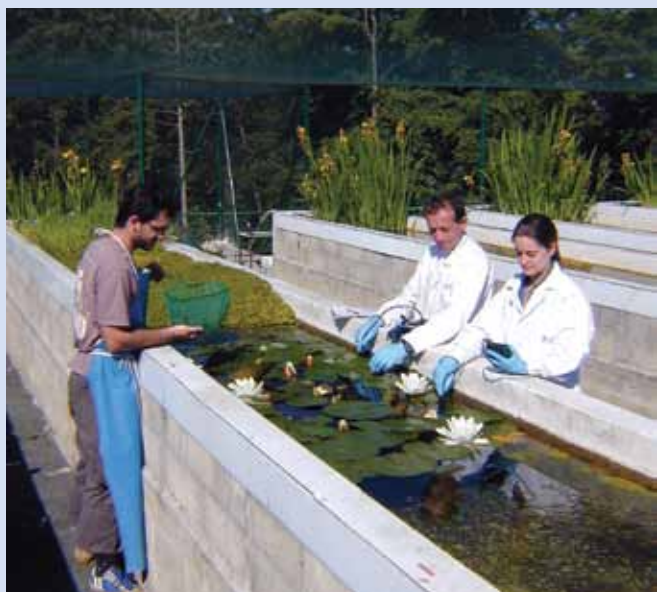
Pour étudier les effets des polluants sur les écosystèmes, l'Ineris utilise un mésocosme, un dispositif expérimental clos qui simule à moyenne échelle les conditions d'un milieu aquatique.
