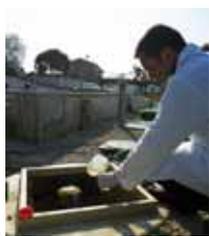
Des prélèvements sont effectués quotidiennement : entrée et sortie de chacun des éléments des filières, biomasse épuratrice et boues résiduelles... pour les analyses en laboratoire.
