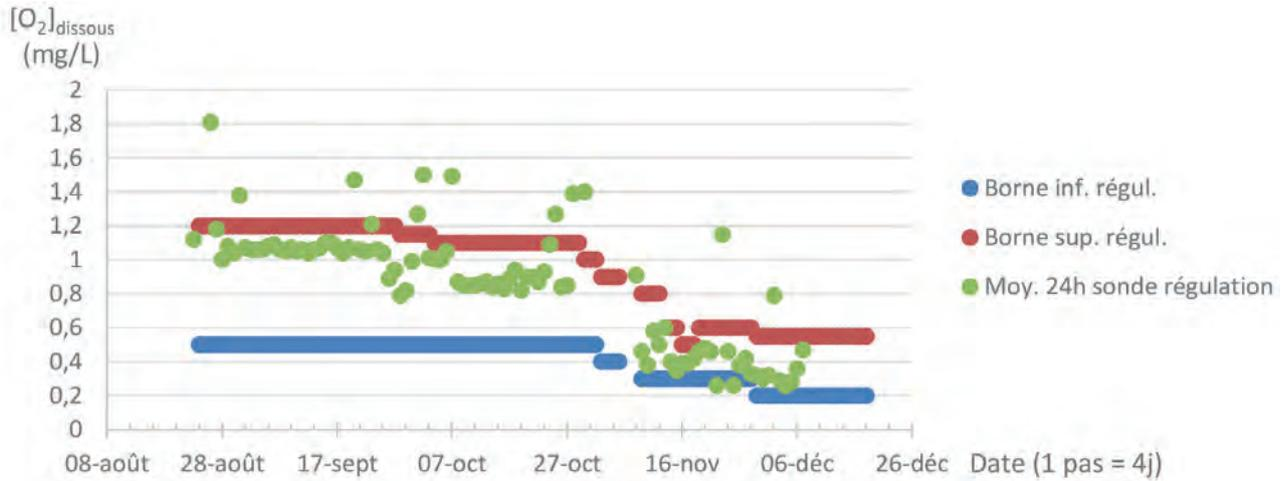
Figure 3 : Evolution au cours du temps de la concentration moyenne sur 24h de l'O<sub>2</sub> dissous, avec les seuils haut et bas
