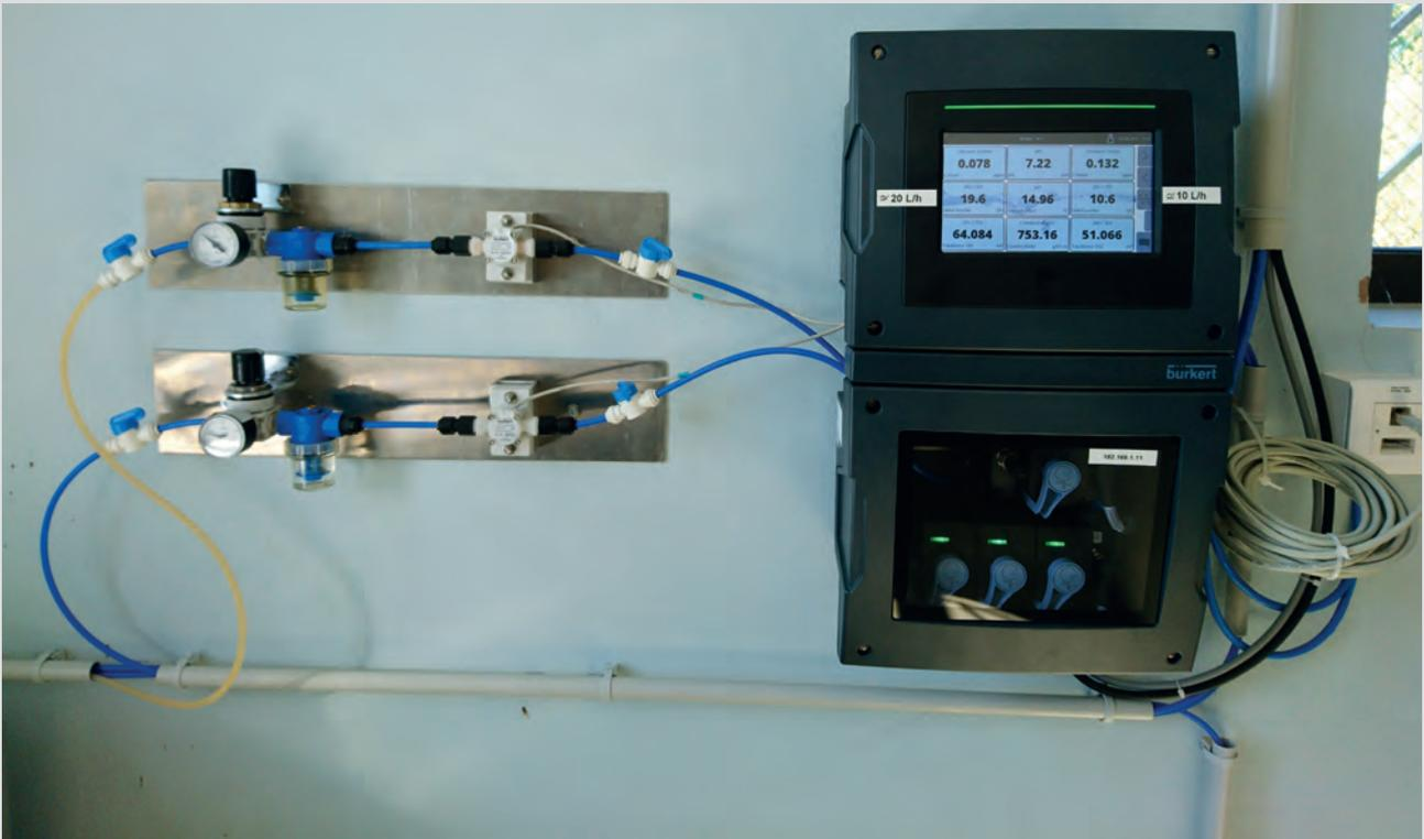
Les analyseurs d'eau 8905 utilisent des systèmes microélectromécaniques ou MEMS (microelectromechanical systems). Fabriquée en France, cette microtechnologie rend les capteurs aussi petits qu'un composant de carte à puce et sont d'une grande fiabilité.
