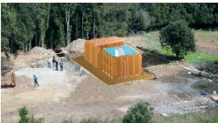
La station proposée est une unité de type WWB Waste Water Box avec une structure bois fonctionnant avec le procédé UniBioCell® basé sur un système de type SBR (Sequencing Batch Reactor).
