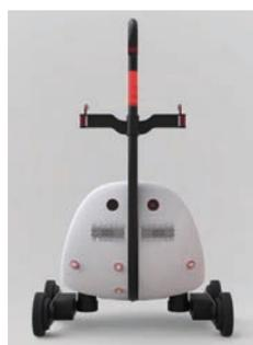
L'e-robot développé en partenariat avec la start-up Borobo apporte une assistance robotisée (jusqu'à 70 kg) aux opérateurs allégeant ainsi les contraintes du déplacement et du port de charges.
