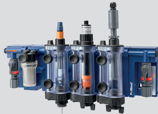
Exemple : Chambre d'analyse BAMA avec 4 modules : Filtre, sonde pH, sonde chlore et détecteur de passage d'eau
